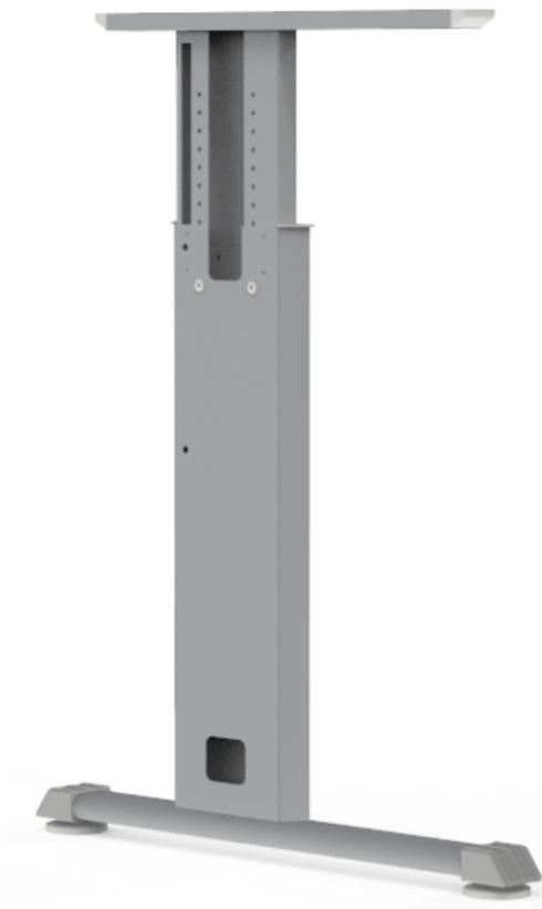
Pata regulable formada por una cremallera de agujeros roscados para tornillos de métrica 6 con una distancia entre ellos de 2 cm pudiéndose elevar manualmente la altura de la mesa de 74 cm a 100 cm.
